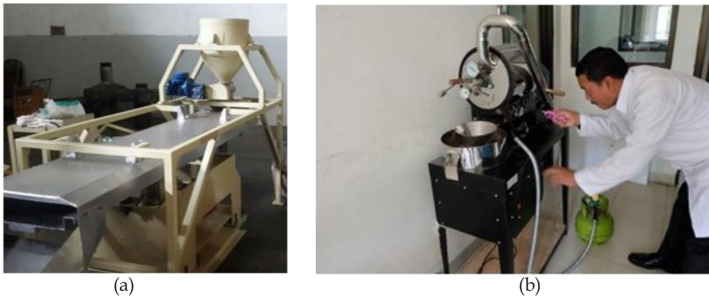
Gambar 1. Alat penyangrai biji kakao. Vibro-fluidized roaster (a); penyangrai konvensional (b)
