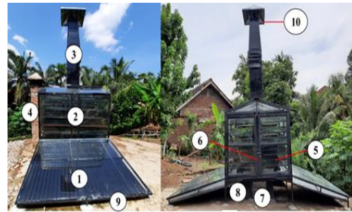
Gambar 1. Alat Pengering Sebelumnya (1- Kolektor, 2-Ruang Pengeringan, 3- Cerobong Depan, 4-Terowongan Gas Buang, 5-Rak, 6-Penukar Panas, 7-Tungku, 8-Saluran Udara, 9-Inlet Udara, 10- Outlet Udara)
