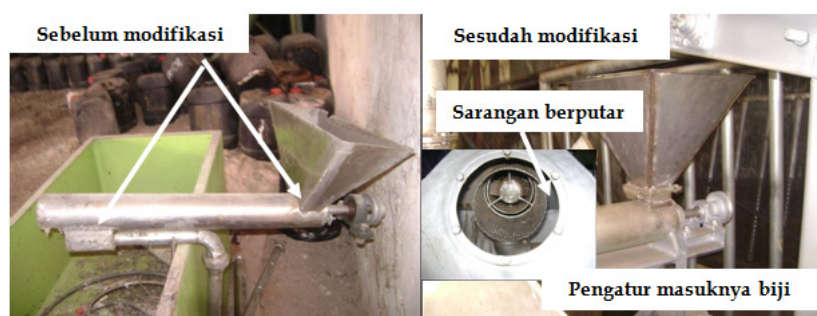
Gambar 4. Modifikasi pemasukan biji dan pembasahan dengan sarangan berputar
