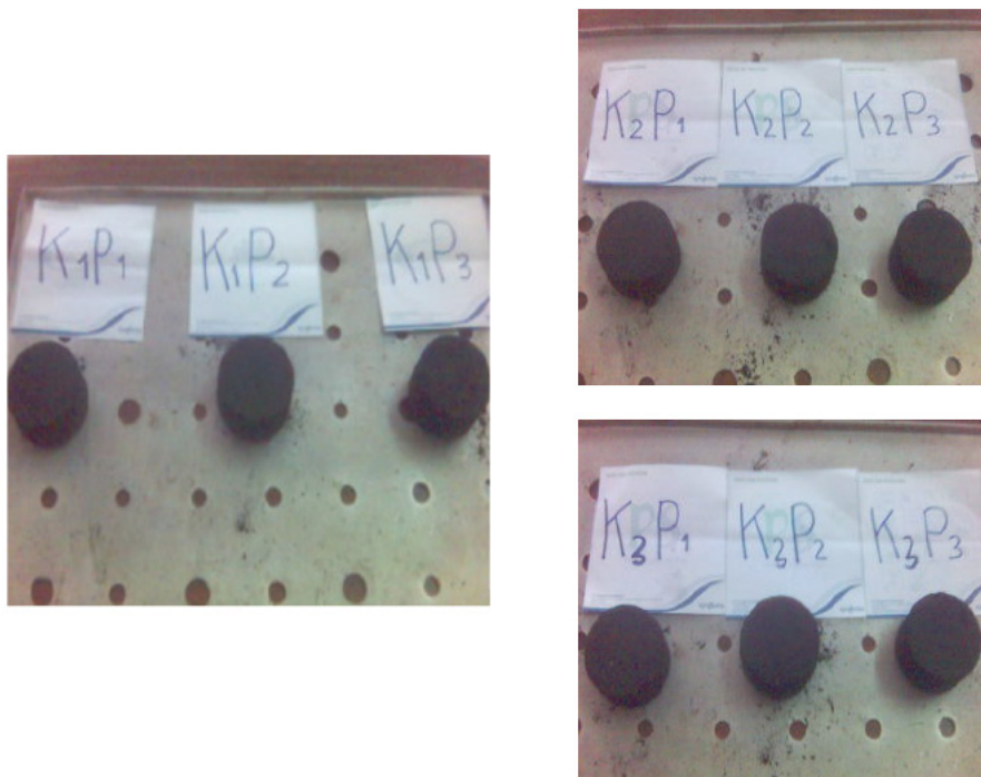
Gambar 2. Briket hasil eksperimen dengan sembilan total perlakuan
