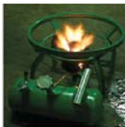
b. Kompor bertekanan tipe Protos (Prastowo, 2008)
