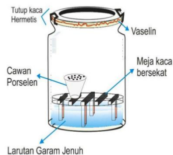
Gambar 1. Sketsa desikator (modifikasi Hutasoit N, 2009)
