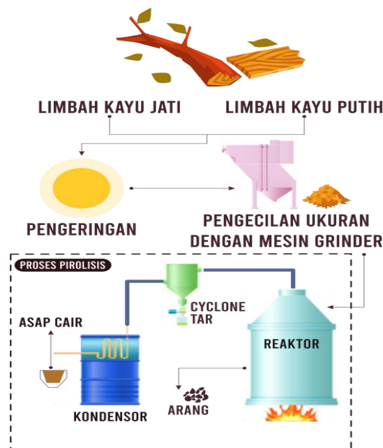
Gambar 1. Diagram kerja proses pembuatan asap cair
